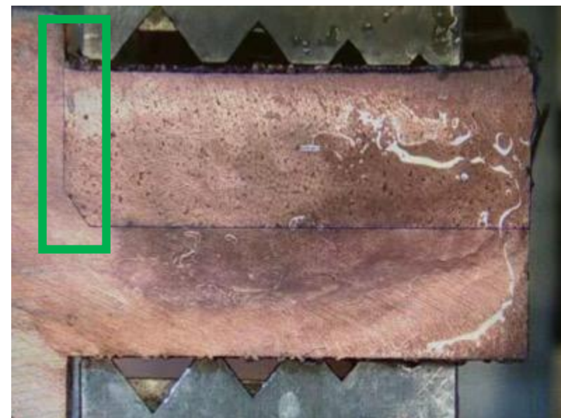
更好的过电流与导热能力- 线材与端子侧壁直接接触
