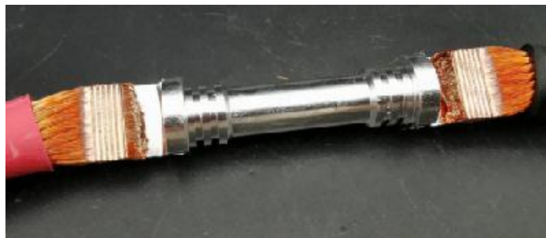
中间端子 两头焊70mm 2 铜线
