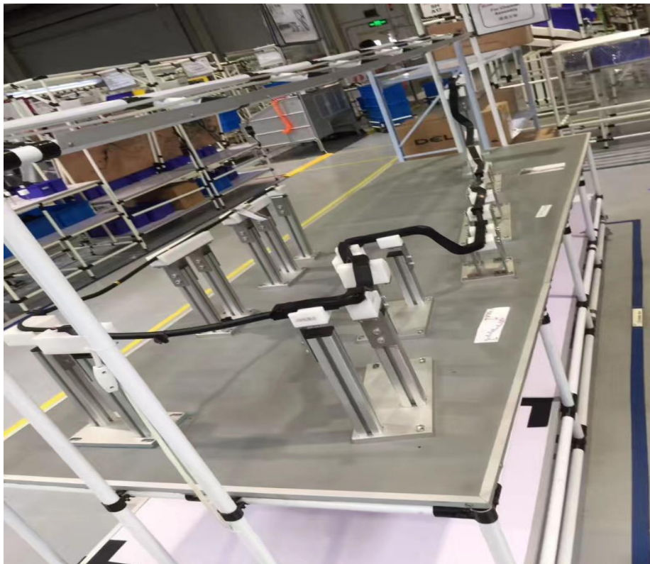
电池线项目工装
