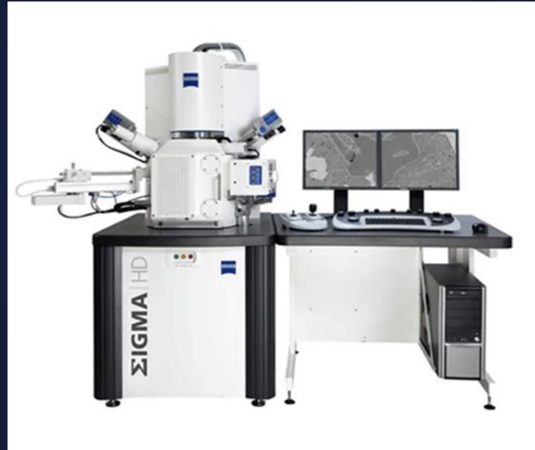
扫描电子显微镜（连接器金属材料分析及 失效成分分析）放大倍数：2X-20万
